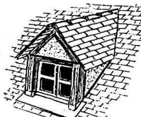
lucarne jacobine, en bâtière ou à chevalet
